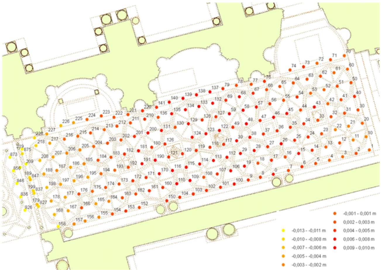
Figura, 14. Differenza fra punti topografici (Control points) e Dtm da nuvole laser scanner nel nartecce nord
