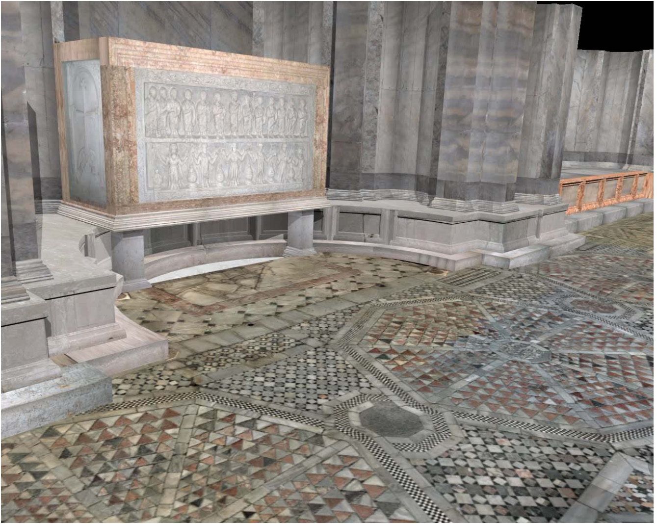
Figura, 28. La modellazione del pavimento entro gli alzati architettonici, rilevati con Laser SH3000 Leica e testurizzato in 3D con le immagini (2007-2009). Particolare del transetto nord
