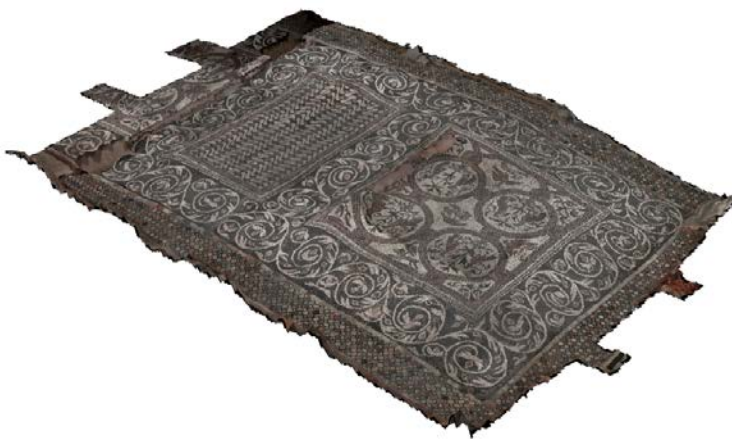
Figura, 5. Camera Rollei DB44 Metric Figura, 6. Ortofoto digitale 3D della zona sperimentale del pavimento della Basilica di San Marco
