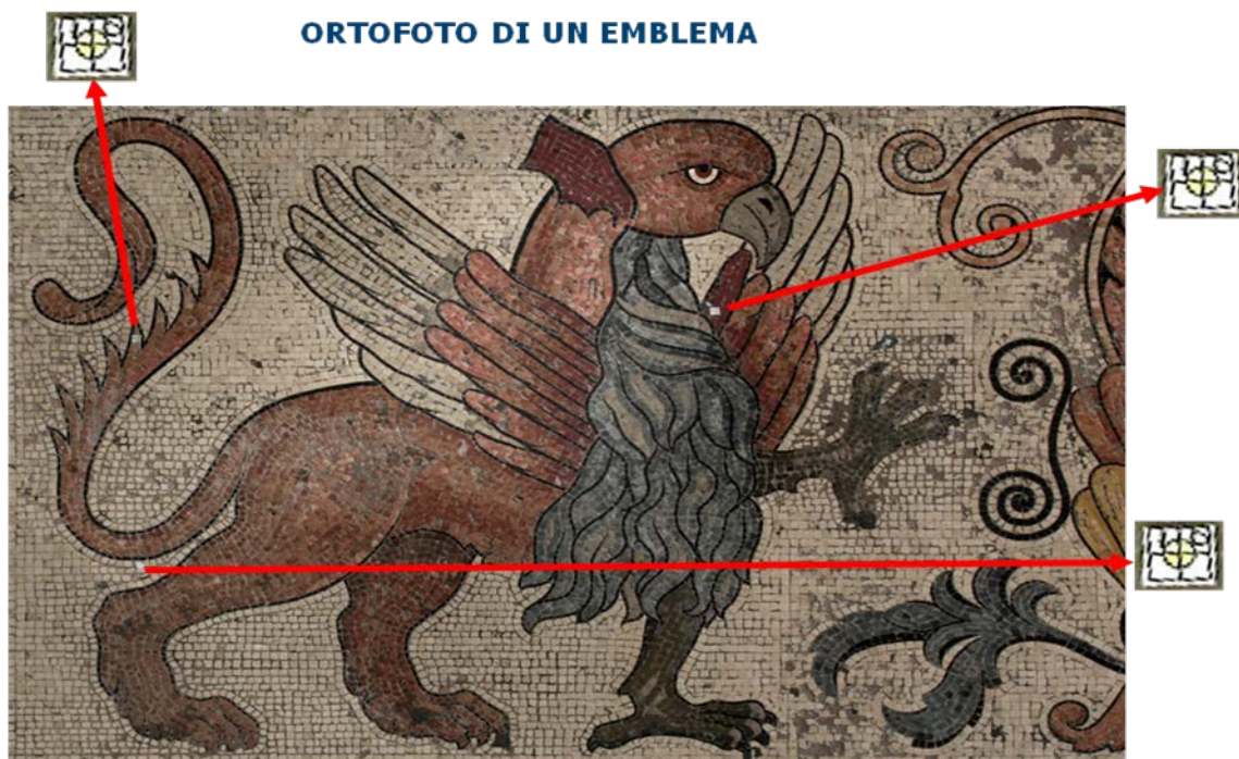
Figura, 17. Ortofoto di un emblema con visualizzati 4 dei 3800 GCP (adesivi di 1cm x 1cm con bersaglio)
